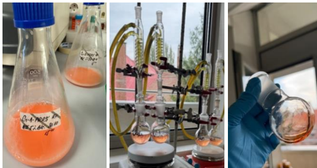
Cultivare în flacon de 500 ml a clonei selectate (stânga) și etape de extracție și procesare a lipidelor: extracția Folch cu reflux (mijloc) și concentrarea probei de lipide prin evaporare rotativă (dreapta)
