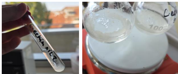
Extract lipidic obținut din cultură (stânga) și procesul de extracție a lipidelor prin metoda Folch cu reflux (dreapta)
