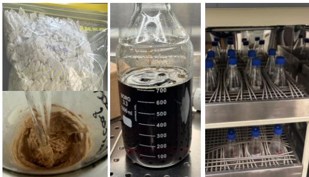
Bucăți de țesătură de bumbac tratate cu acid în timpul hidrolizei (stânga), hidrolizat lignocelulozic obținut (mijloc) și cultivări în flacoane de 500 mL ale tulpinii parentale și celor evolute, incubate în condiții obișnuite (dreapta)
